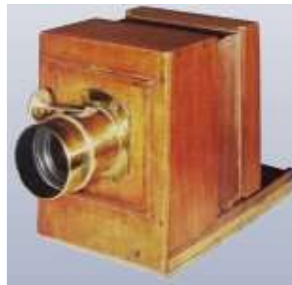
Πρώτες μηχανές νταγκεροτυπίας (~1840)
